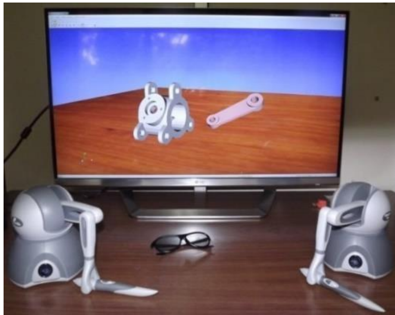
Figura 7.3 Interfaz háptica del sistema de ensamblaje virtuales HAMS
